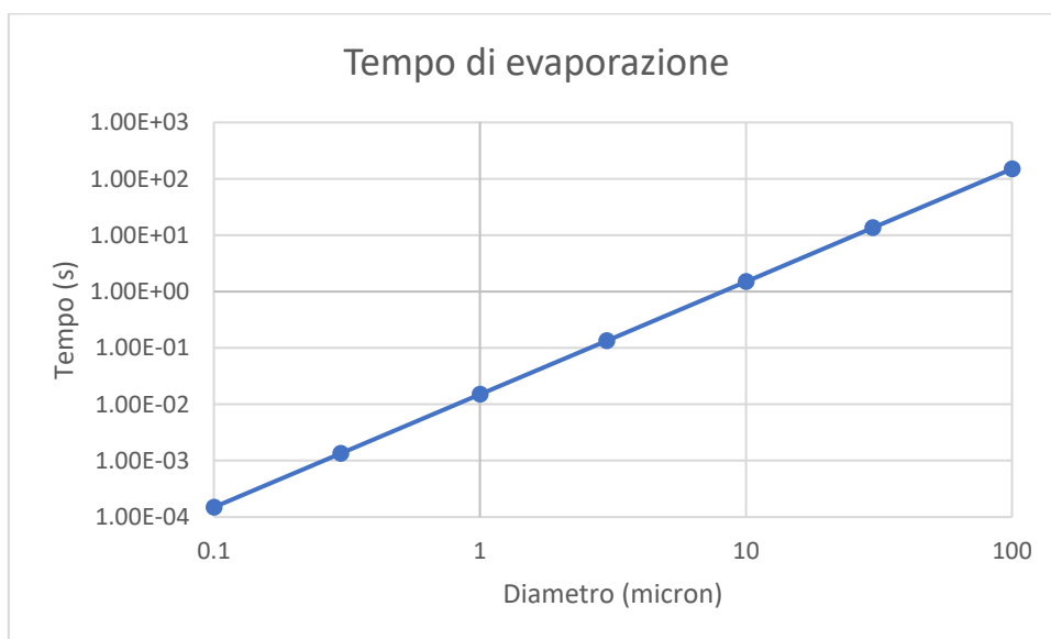
Figura 6: dipendenza del tempo di evaporazione delle goccioline dal loro diametro, calcolato per T = 15^\circ\text{C} e RH = 70\% .
