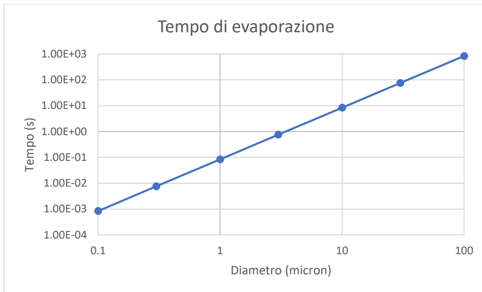
Figura 7: dipendenza del tempo di evaporazione delle goccioline dal loro diametro, calcolato per T = 15^{\circ}\text{C} e RH = 95\% .
